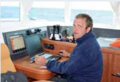
△ Lagoon 440 kan styras inifrån med hjälp av dubbla motorreglage och joystick.
