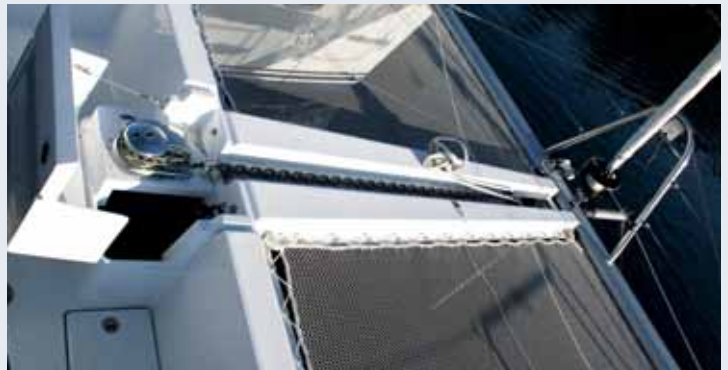
△ Ankarspelet är placerat så att kättingen förvaras så långt akterut som möjligt – allt för att båten ska röra sig smidigt i sjön.
